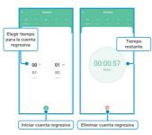
Si el contacto está encendido, al terminar el conteo, se apagará; si está apagado, se encenderá.
